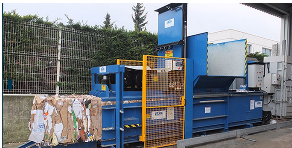
Figure 4. Photographie d'une presse à balle horizontale, source : Pressor
